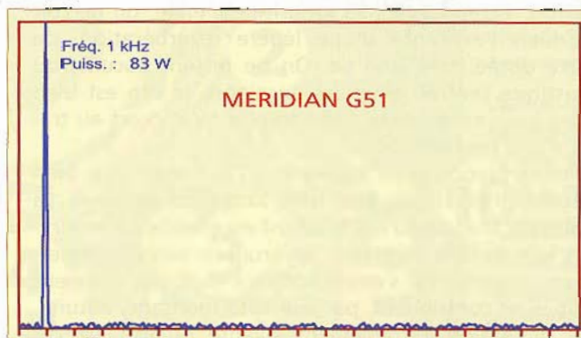
Spectre de distorsion à -1 dB Pas de distorsion significative selon nos critères à 83 W.
